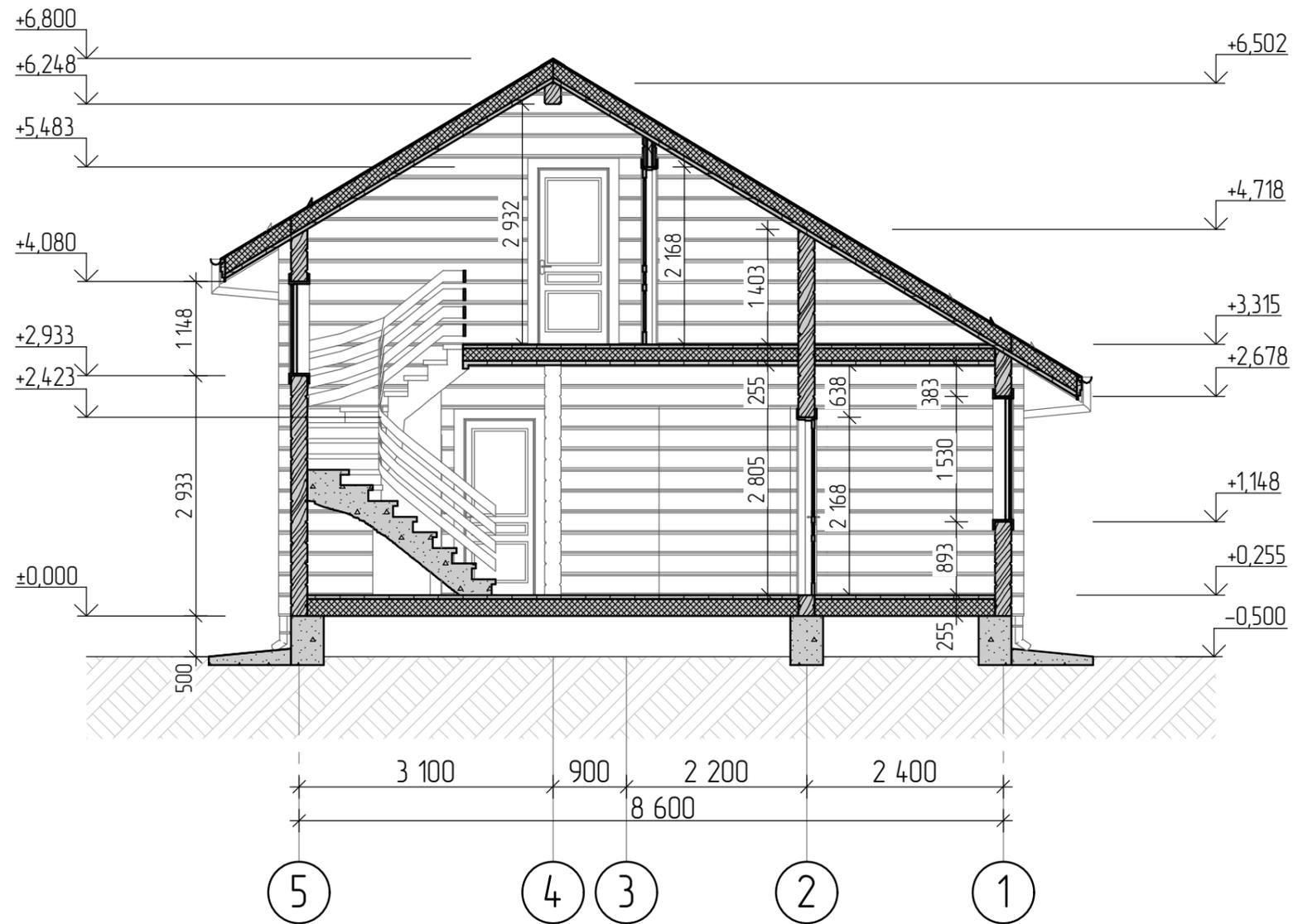
Примечание: все высотные отметки кратны рабочей высоте сечения бруса
