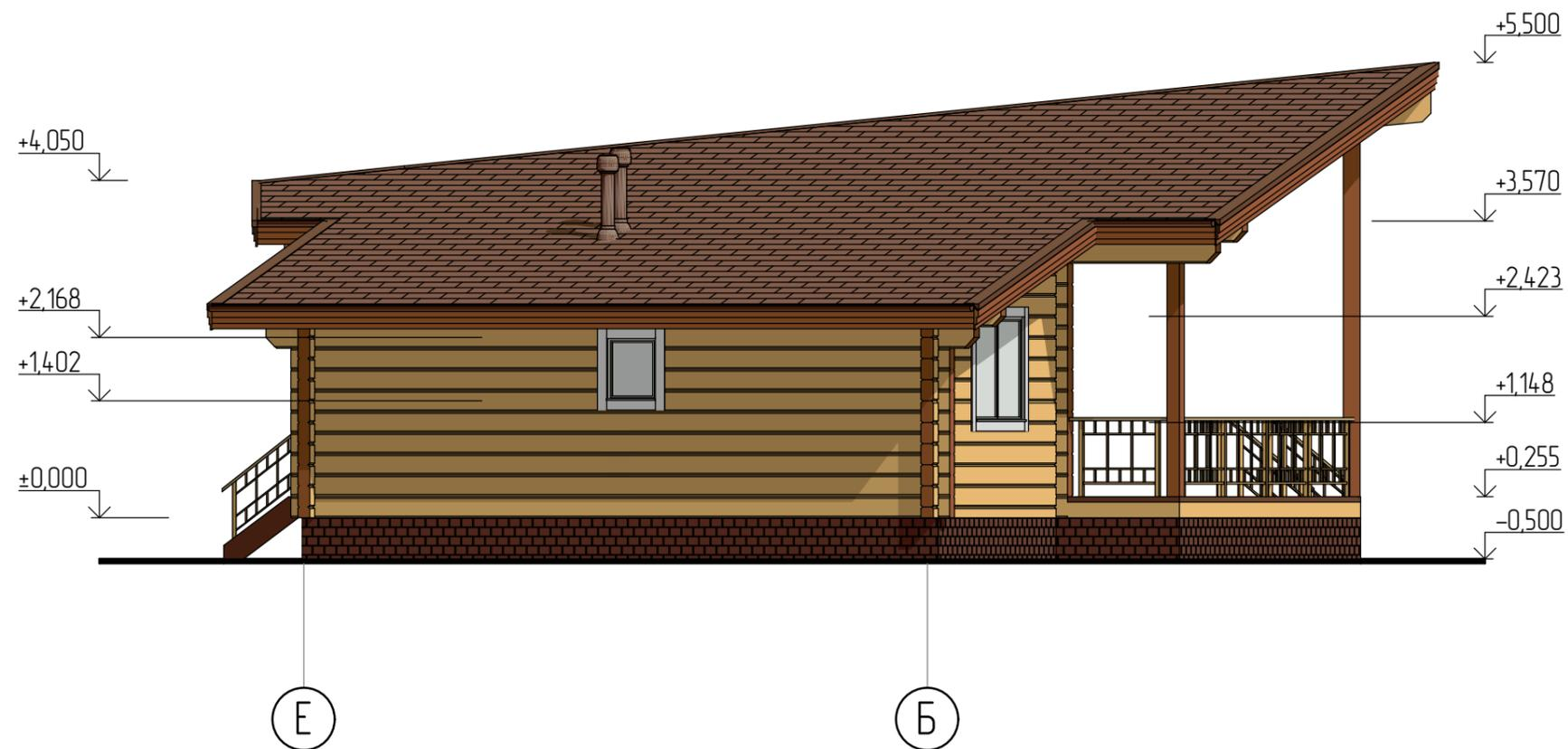
Примечание: все высотные отметки кратны рабочей высоте сечения бруса
