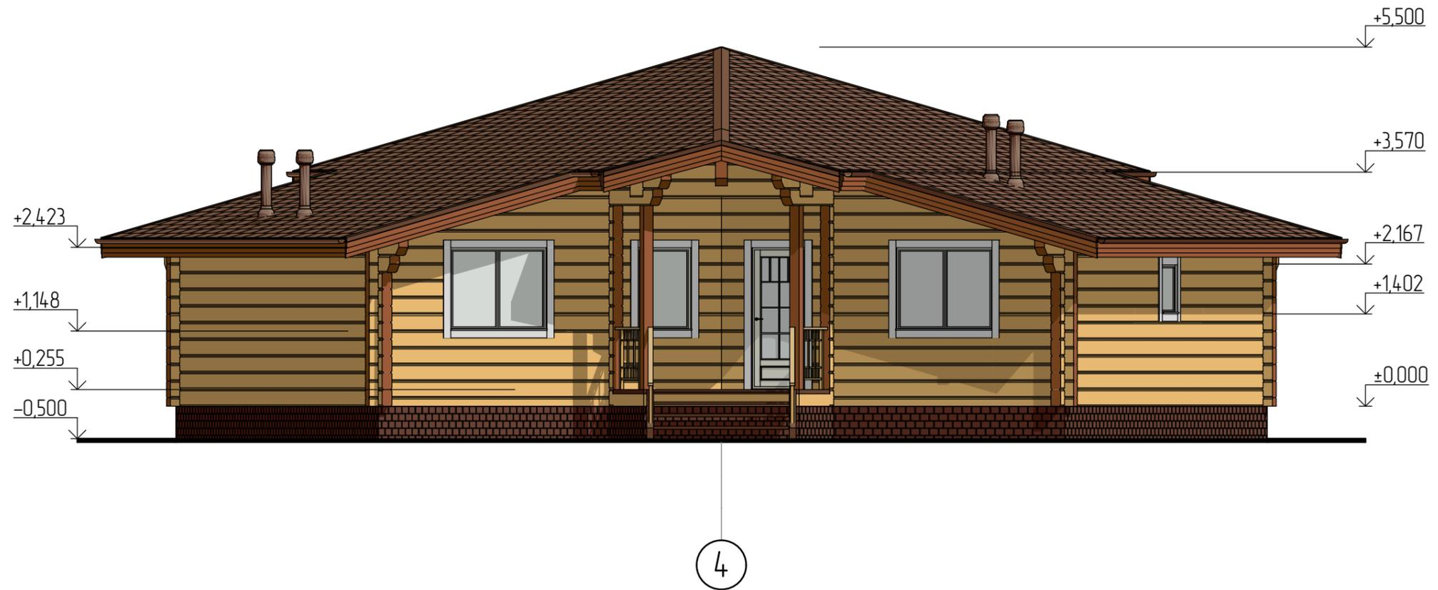
Примечание: все высотные отметки кратны рабочей высоте сечения бруса
